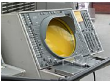
pantalla de tubs iconoscòpics amb radars de detecció (Operació Sage)
